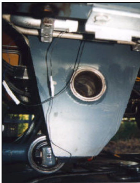
FIGURE 8 : transmission solidienne du bruit de roulement vers l'intérieur du véhicule, diagnostic par mesures simultanées du bruit et des vibrations
