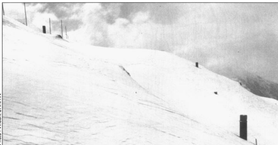
▲ Figure 4 : Disposition des quatre détecteurs Arfang sur le terrain (colonnes noires), avec une distance de 30 m des trois détecteurs par rapport au détecteur central.
