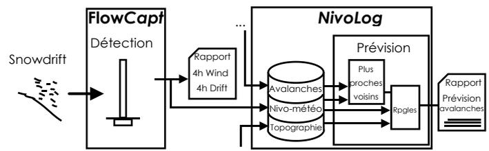
▲ La mesure automatique "Snowdrift" s'inscrit dans le concept plus général de la chaîne de prévision automatique des risques d'avalanches, qui consiste en une intégration standard des capteurs d'observation nivo-météorologique sur les sites au système de prévision.
