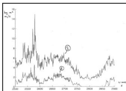
◀ Enregistrement simultané du snowdrift (1) et de la vitesse du vent (2), à Anzère, le 10.1.96, par foehn violent [5]. La comparaison des deux enregistrements permet de distinguer le seuil de déclenchement du transport par saltation.
