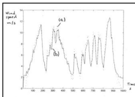
◀ Comparaison des vitesses de vent relevées en soufflerie, par (a) un anémomètre type MiniAir@05 et (b) l'anémo-driftomètre prototype Eoleige, placés côte-à-côte [5].
