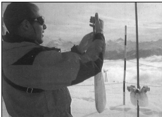
▲ Sur le terrain, le "snowdrift" est mesuré au moyen du driftomètre, ou d'autres systèmes manuels ou semi-automatiques [3]. Avec le driftomètre, chefs de sécurité et pisteurs pèsent régulièrement des sachets lors des périodes de transport. Le "snowdrift" est également obtenu par estimation, à partir de données indirectes, mesurées ou calculées.
