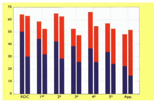
Niveaux à 100 et 200 hertz en dB relevés dans l'escalier au-dessus de la cellule à la station de Pierre-de-Plan, du Service de l'électricité de la Ville de Lausanne.
